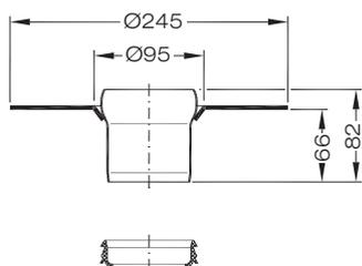
**Aufsatzelement mit Muffe**
